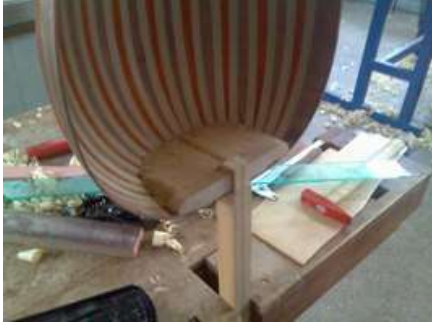
Resim 2.10: Sapın tekneye alıştırılması
