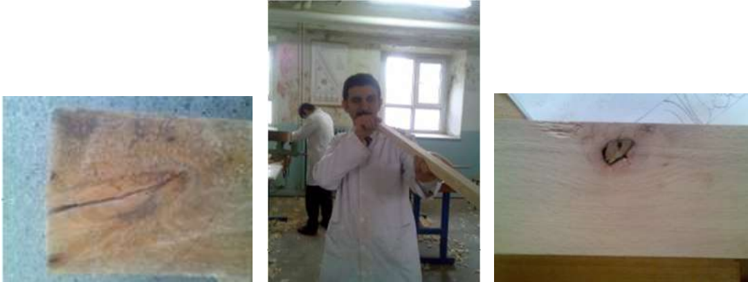
Resim 2.6: Budak ve sapta oluşabilecek eğriliğin gözle kontrolü
