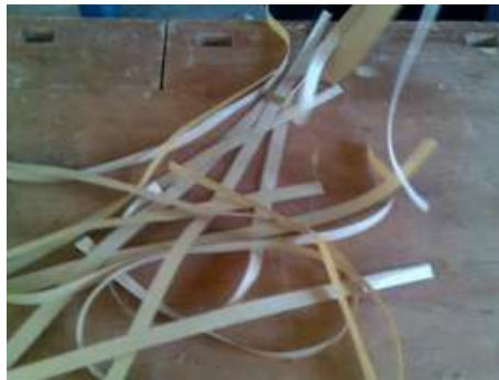
Resim 1.9: Tekne içinin bantlanmasında kullanılacak kâğıtlar
