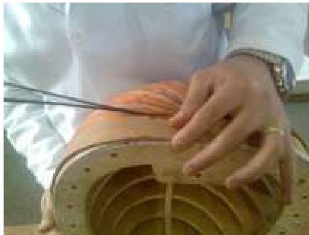
Resim 1.4: Filatonun dilimle birlikte kalıba yapıştırılması
