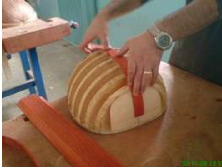
Resim 1.2: Orta dilimin kalıba göre alıştırılması
