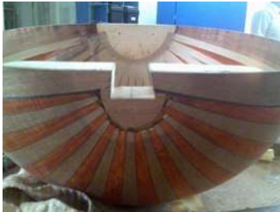
Resim 2.8: Tekneye kırlangıçkuyruğu açma
