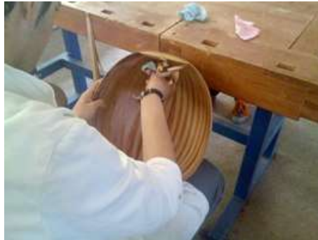
Resim 1.12: Kâğıt bantların tutkallı bezle silinmesi
