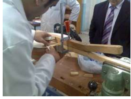
Resim 2.11: Sapın tekneye montajı
